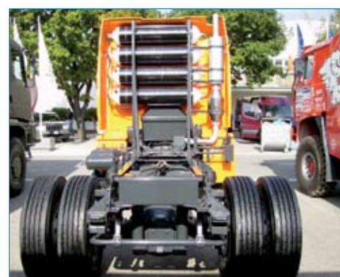
Tlakové láhve na stlačený zemní plyn na voze TEDOM.
